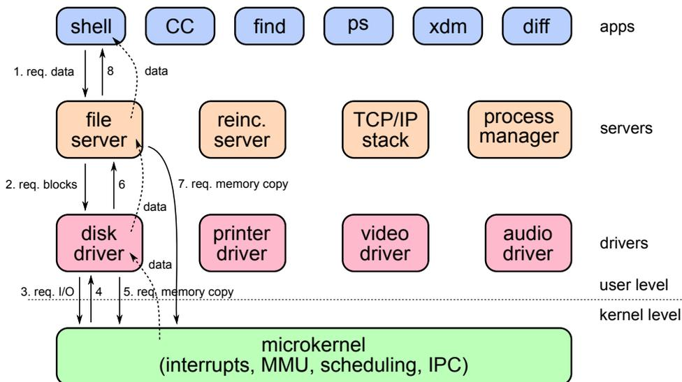
Figura 3.2: Visão geral da arquitetura do MINIX 3 (adaptado de [Herder et al., 2006]).
