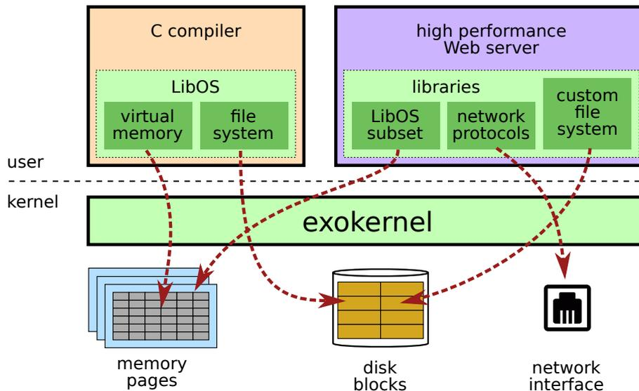
Figura 3.6: Sistema exonúcleo (adaptado de [Engler, 1998]).
