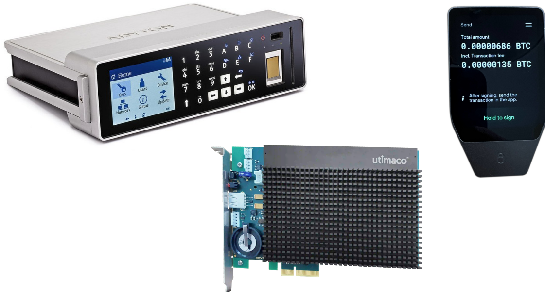
Figura 10.3: Módulos de segurança em hardware (HSM). Da esquerda para a direita: módulo HSM autônomo, placa HSM e carteira física de criptomoedas.
