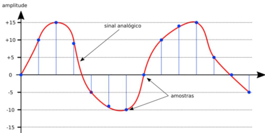
Nessa figura podem ser identificados o **sinal analógico**, proveniente de um microfone ou outro dispositivo de captura, e as **amostras**, que correspondem ao valor do sinal medido em intervalos regulares. O sinal analógico acima seria então representado de forma aproximada pelo seguinte vetor de amostras:
