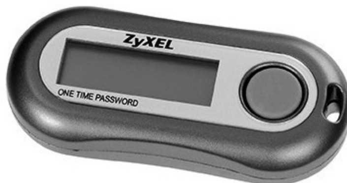
Figura 17: Um dispositivo gerador de senhas descartáveis.
